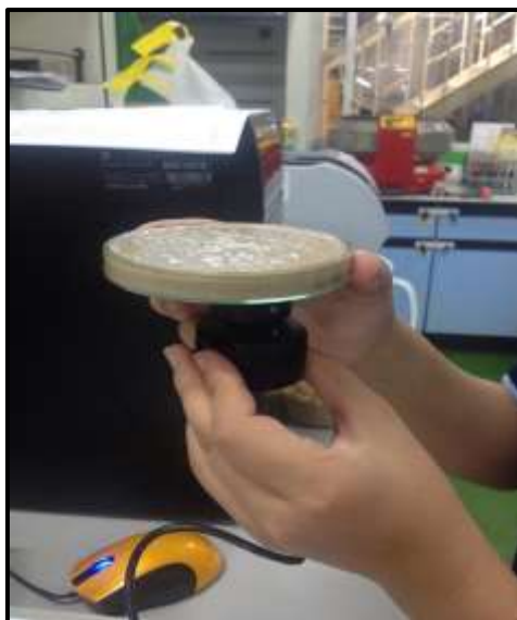
รูปที่ 3.5 การสแกนด้วยเครื่อง Long wavelength diode array spectrometer (MicroNIR, JDSU, USA) ที่ช่วงความยาวคลื่นยาว 1150-2150 นาโนเมตร
