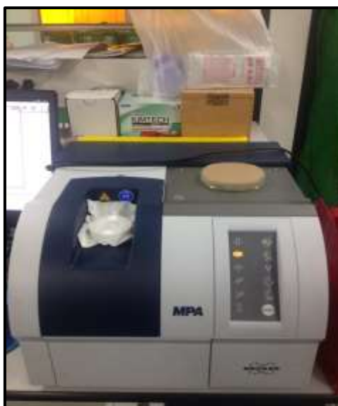
รูปที่ 3.6 การสแกนด้วยเครื่อง FT-NIR spectrometer (MPA, Bruker, Germany) ที่ช่วงเลขคลื่น 12500-4000 \text{cm}^{-1} (800-2500 นาโนเมตร)
