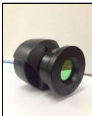
รูปที่ 3.3 เครื่อง Long wavelength diode array spectrometer (MicroNIR, JDSU, USA)
