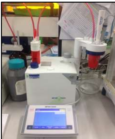
รูปที่ 3.8 การตรวจวัดปริมาณเกลือด้วยวิธีดั้งเดิม โดยใช้เครื่องไตเตรทอัตโนมัติ (T50, Metler Toledo, USA)
