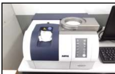
รูปที่ 3.4 เครื่อง FT-NIR spectrometer (MPA, Bruker, Germany)
