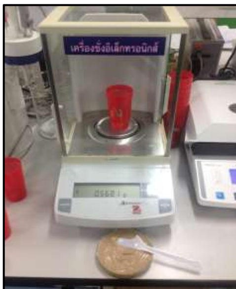
รูปที่ 3.7 ชั่งน้ำหนักด้วยเครื่องชั่งไฟฟ้า (ARC140 Adventure, OHAUS ความละเอียด 0.0001 g)
