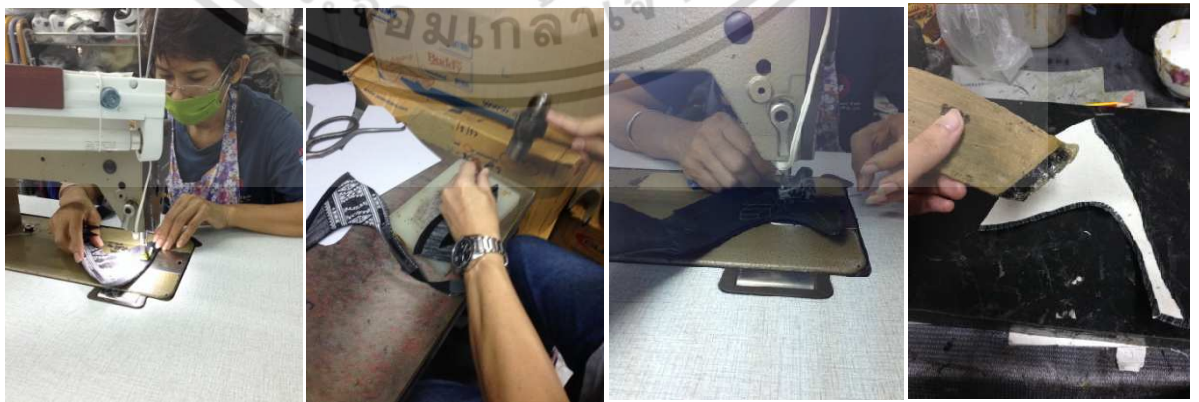
รูปที่ 6.7 ขั้นตอนการประกอบหนังหน้า
