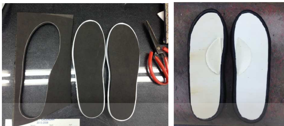
รูปที่ 6.10 ขั้นตอนการประกอบพื้นในรองเท้า
