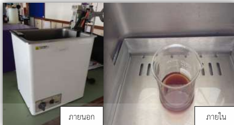
รูปที่ 3.5 ถึงปฏิกรณ์ที่เป็นชุดการทดลองแบบแบทช์ (กระบวนการโซโน-เฟนตัน)
