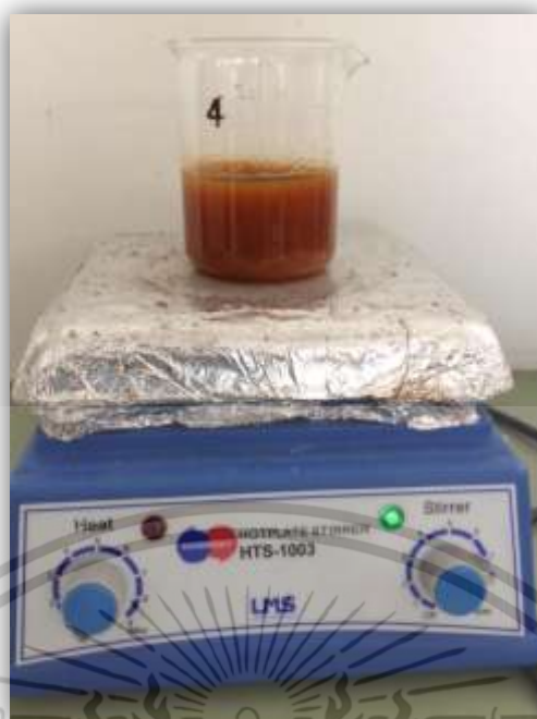
รูปที่ ฉ-7 ชุดการทดลองแบบแบทช์ (กระบวนการเฟนตัน)
