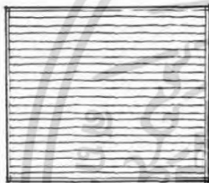
E. ผนังไม้ตีซ้อนเกล็ด แนวนอนโครงเคร่าด้านใน
