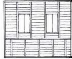
D. ผนังไม้กระดานตีซ้อน เกล็ด แนวนอนตีทับแบบ ปะกน
