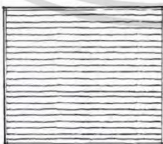
N. ผนังไม้เซอร่าตีซ้อนเกล็ด แนวนอนโครงเคร่าไม้ด้านใน
