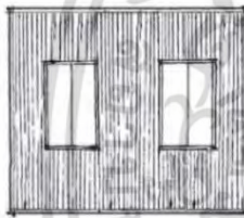
ผนังสังกะสีโครงเคร่าไม้ ด้านใน
