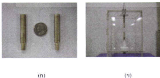
รูปที่ 3 (ก) ลักษณะของแท่งตัวนำตัดเทียบกันหรือดูขนาด (ข) ช่องว่างอากาศแบบแท่ง-แท่งที่ประกอบภายในตู้
