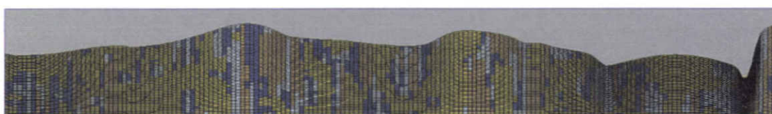
รูปที่ 5.19 ภาพตัดขวางแบบจำลองความเป็นไปได้การกระจายตัวของชั้นดิน Len length ratios = 20 กริด I=150 Realization 1
