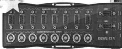
รูปที่ 4.2 การ์ดรวบรวมข้อมูล (Data acquisition) รุ่น DEWE - 43
