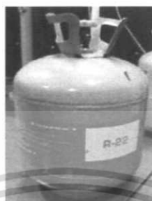
รูปที่ 4.2 ถังบรรจุสารทำความเย็นชนิด R-22 ขนาดบรรจุ 4 กิโลกรัม
