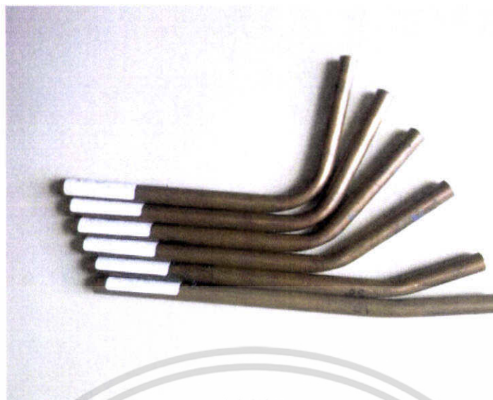
รูปที่ 5.10 แสดงลักษณะของท่อทองแดง B88 หลังการตัดขึ้นรูป
