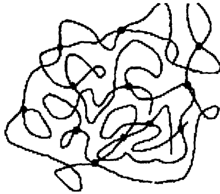
รูปที่ 3.2 ลักษณะเส้นใยพลาสติกแบบ Thermosetting
