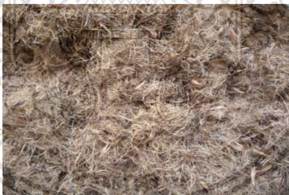
รูปที่ 2.9 เส้นใยเปลือกผลปาล์มที่บีบน้ำมันแล้วที่ใช้ในงานวิจัย ขนาดเล็กกว่า 80 mesh
