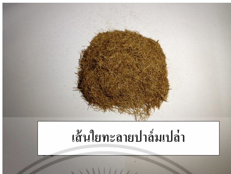
รูปที่ 2.13 เส้นใยทะเลลายปาล์มเปล่าที่ใช้ในงานวิจัย ขนาดน้อยกว่า 80 mesh
