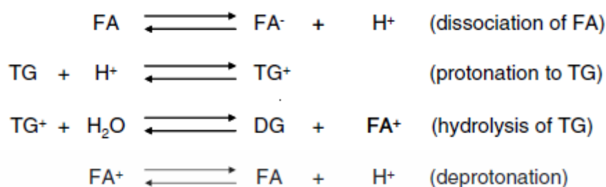
รูปที่ 2.3 กลไกการเกิดปฏิกิริยาไฮโดรไลซิสโดยมีกรดไขมันเป็นตัวเร่งปฏิกิริยา
