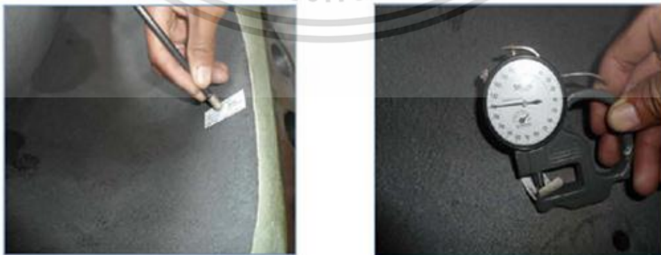
รูป ข - 5 ทำการตรวจเช็คโปรไฟล์ผิว (ค่ายอมรับที่ 75 - 125 ไมครอนมิลลิเมตร)
