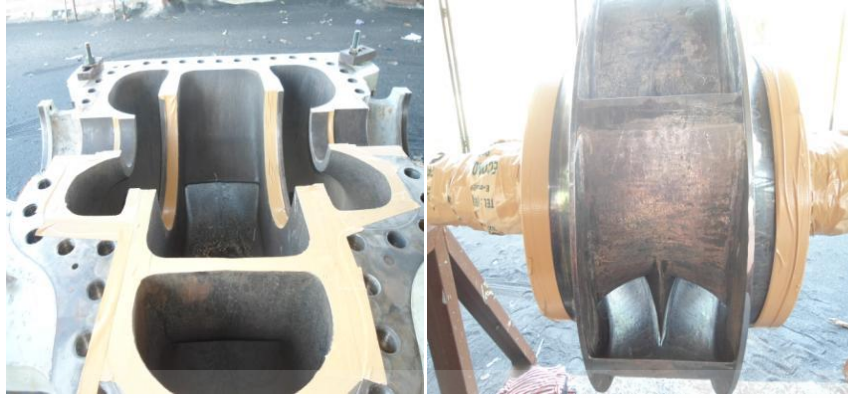
รูปที่ 4.9 ก่อนทำการเคลือบผิวภายในตัวเรือนปั๊มและใบพัด
