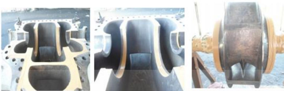
รูป ข - 2 ทำความสะอาดผิวโดยการพ่นทรายด้วยผงทองแดง
