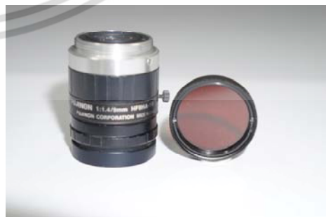
รูปที่ 5.2 เลนซ์และตัวกรองคลื่นแสงย่านสีแดง (620-650 Narrow band pass filter)
