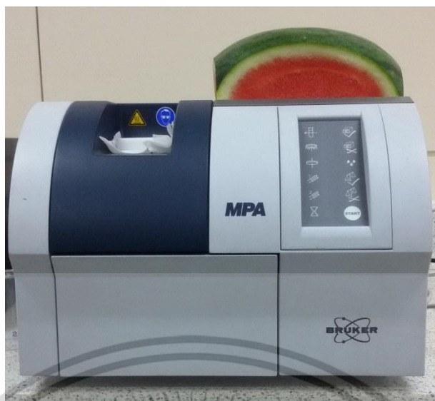
ภาพที่ 3.8 สแกนเนื้อแตงโมด้วย FT-NIR Spectrometer
