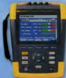
Fluke 438-II วิเคราะห์กำลังไฟฟ้า/มอเตอร์
