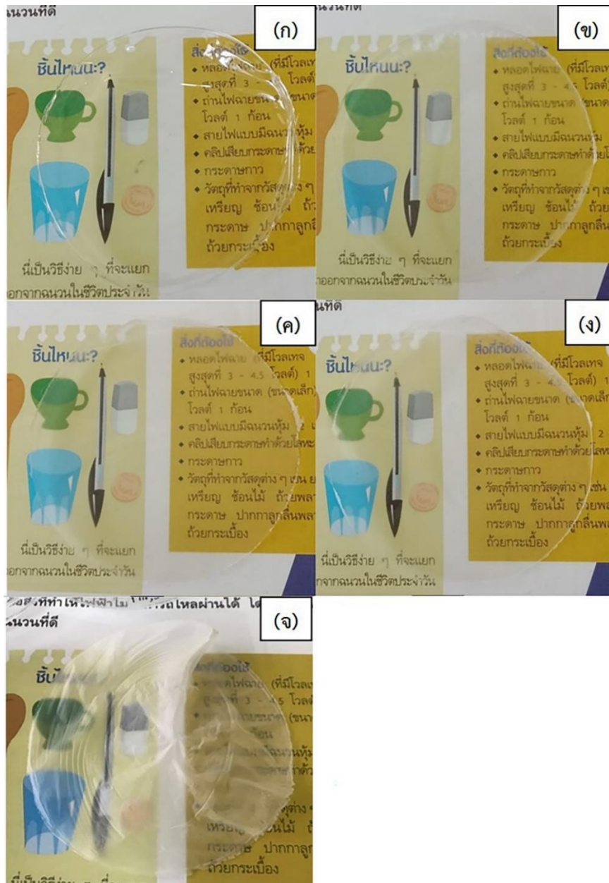
รูปที่ 6. การขึ้นรูปฟิล์มพลาสติกชีวภาพระหว่างโพลีไวนิลแอลกอฮอล์กับนาโนไฟบริลเซลลูโลส ในอัตราส่วน (ก) 10:0 (ข) 7:3 (ค) 5:5 (ง) 3:7 และ (จ) 0:10 ปริมาตรต่อปริมาตร
