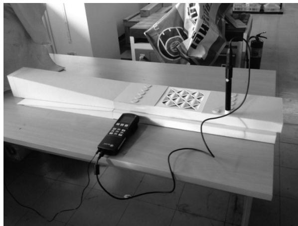
รูปที่ 6 ตำแหน่งติดตั้งเครื่องวัดและบันทึกความเร็วลมผ่านฝ้าชายคา ที่มา: ผู้วิจัย (2560)
