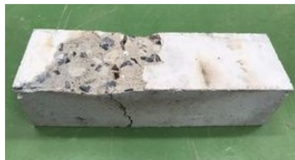
รูปที่ 10 สภาพหลังจากทดสอบกำลังดัดของคานคอนกรีตที่ถูกเผาไหม้
