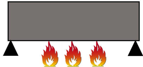
รูปที่ 2 การเผาไฟคานคอนกรีต
