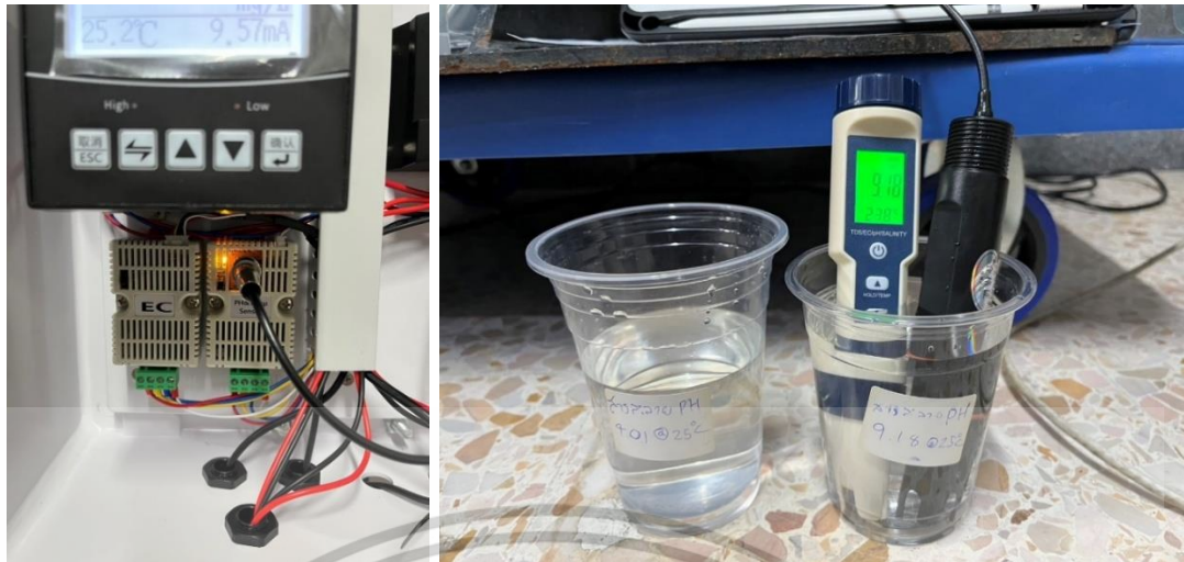
รูปที่ 3.6 การสอบเทียบเซนเซอร์วัดความเป็นกรดเป็นเบส
