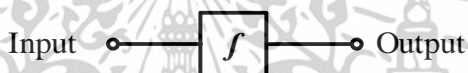
รูปที่ 2.21 สัญลักษณ์ของวงจรอินทิเกรเตอร์
