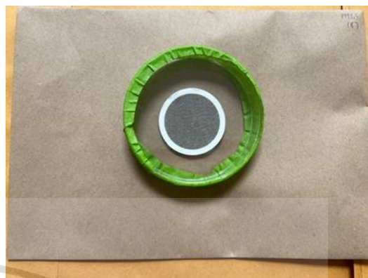
กระดาษกรองหลังเก็บตัวอย่าง PM 2.5 ตัวอย่างที่ 8
