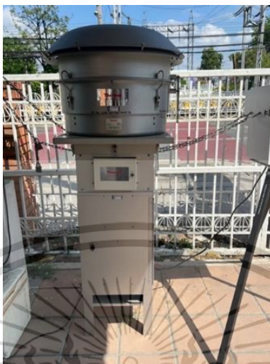
รูปที่ 2.1 เครื่องเก็บตัวอย่าง PM 10 แบบปริมาตรสูง (PM 10 High-volume air sampler)
