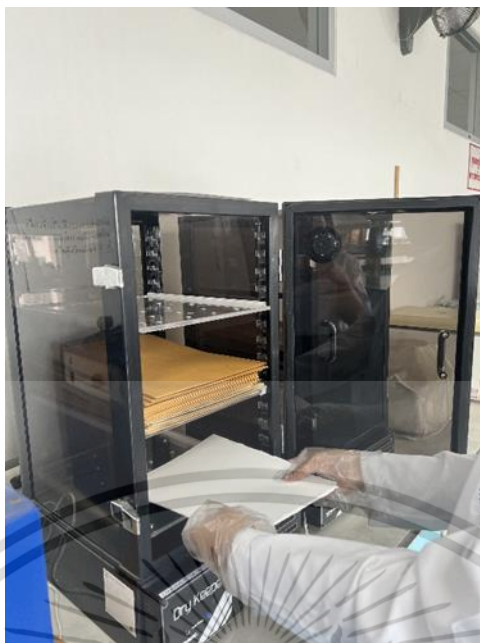
รูปที่ 3.1 การเตรียมกระดาศกรองสำหรับการตรวจวัดปริมาณฝุ่นละออง
