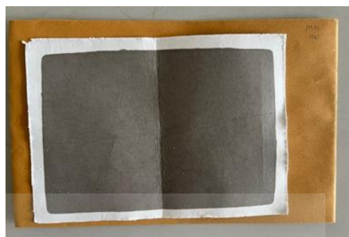
กระดาษกรองหลังเก็บตัวอย่าง PM 10 ตัวอย่างที่ 8
