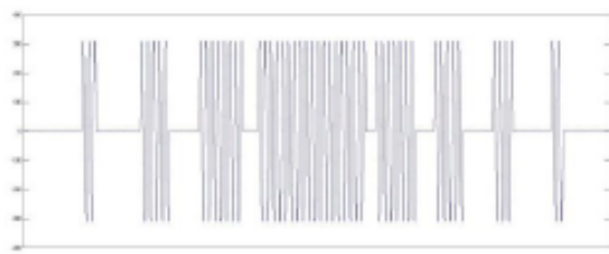
รูปที่ 6 ผลจากการจำลองสัญญาณแรงดันวีซีเคิลคอนโทรลแบบ Close Loop
