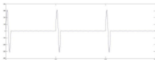
(ก) การจำลองสัญญาณแรงดันที่ Duty Cycle - 0.1
