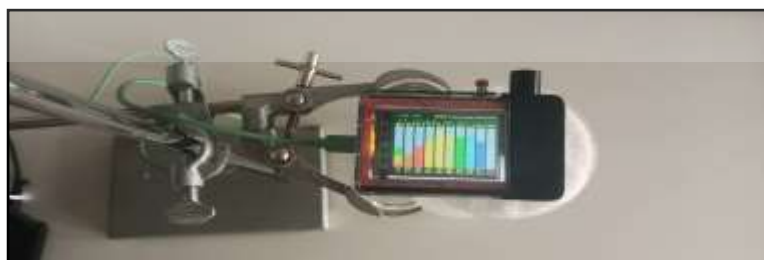
รูปที่ 4.4 ขณะที่เครื่องตรวจจับและพิสูจน์ทราบสารประกอบวัตถุระเบิดแสงเครื่อง แบบเทคนิคทางสเปกโทรสโกปีกำลังทำงานจะปรากฏกราฟขึ้นที่จอแสดงผล
