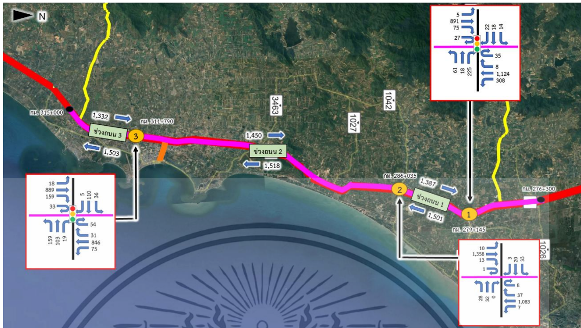
รูปที่ 4.6 แผนภาพรวมปริมาณจราจรบนช่วงถนนและทางแยก
