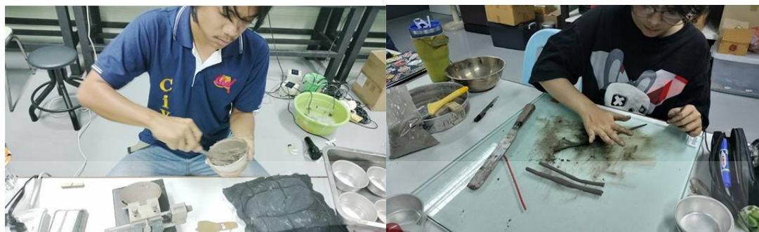
รูปที่ 3.4 การทดสอบ Atterberg's Limits
