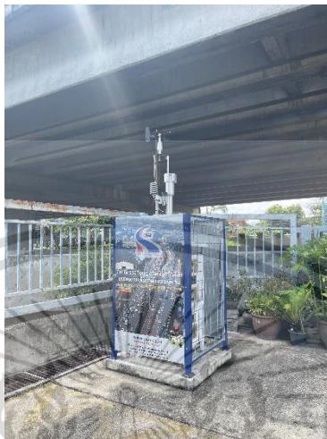
รูปที่ 3.4 เครื่องตรวจวัดคุณภาพสิ่งแวดล้อมออนไลน์ รุ่น T640 ยี่ห้อ Teledyne API
