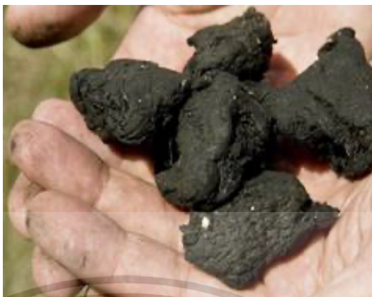
รูปที่ 2.7 กากตะกอนน้ำเสียที่ผ่านการบำบัดแบบไม่ใช้อากาศ (Sewage Sludge)
