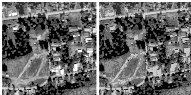
รูปที่ 4.8 ผลลัพธ์ก่อนและหลัง (ขวา) ประยุกต์ใช้ K-means
