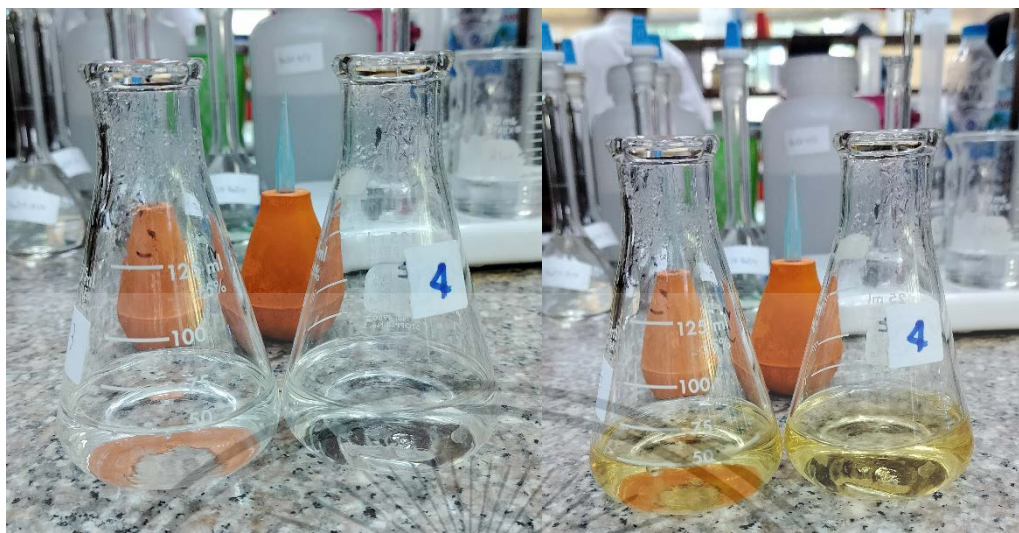
รูปที่ 9 รูปก่อนและหลังเติม Xylenol Orange indicator 3-5 หยด ในวิธีวิเคราะห์ %Alumina
