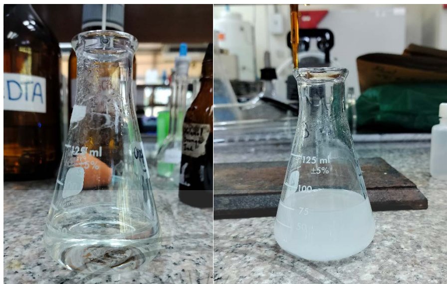
รูปที่ 11 รูปก่อนและหลังเติม KF 25 มิลลิลิตร สารละลายเปลี่ยนจากใสไม่มีสีเป็นสีขาวขุ่น ในวิธีวิเคราะห์ %Basicity
