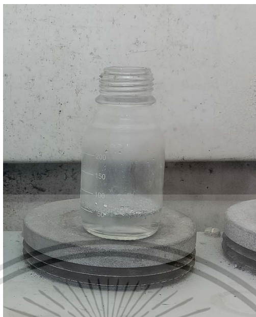
รูปที่ 3 เติมผงอะลูมิเนียมบริสุทธิ์ลง น้ำ + กรดไฮโดรคลอริก 37% ช่วงที่ยังไม่เกิดปฏิกิริยา
