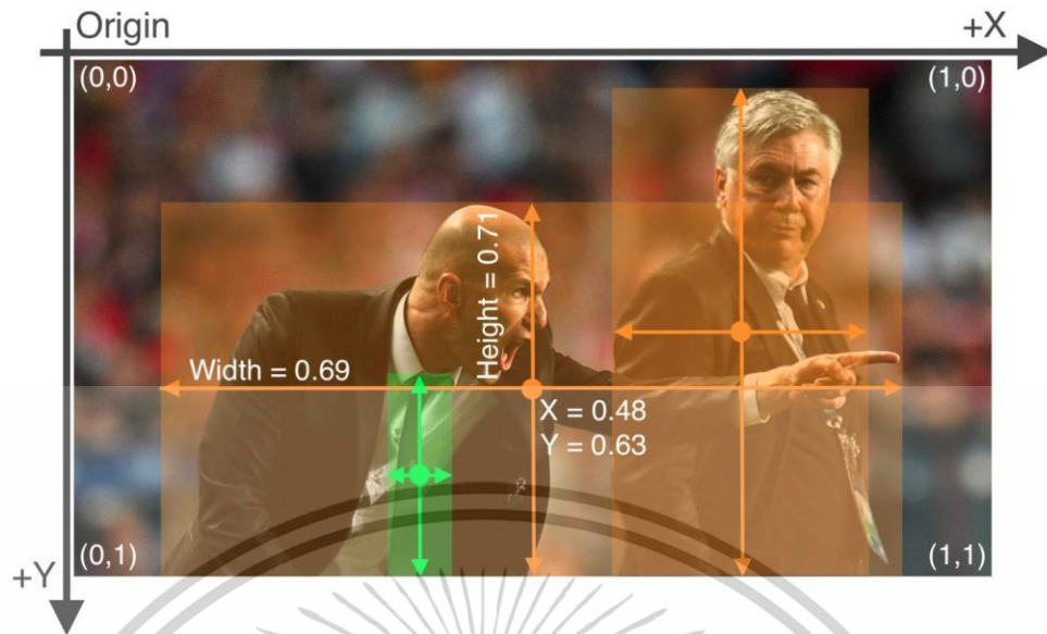
รูปที่ 3.33 ตัวอย่างภาพอธิบายพิกัด x,y,w,h ที่ตรวจจับวัตถุได้
