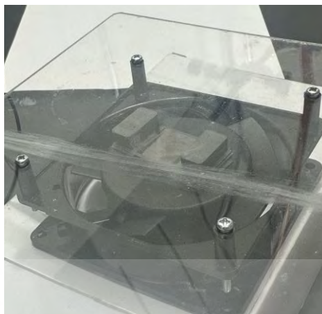
รูปที่ 3.12 ตำแหน่งการติดตั้งแผ่นอะคริลิกใสกับพัดลมระบายความร้อน
