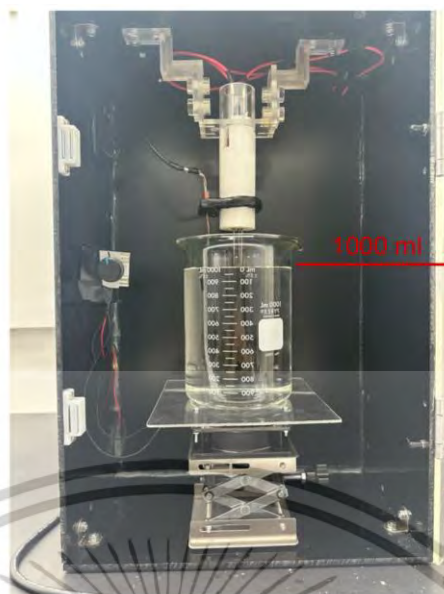
รูปที่ 3.8 การจัดวางตำแหน่งของปีกเกอร์ปริมาตรสูงสุด 1000 มิลลิลิตร และแท่นยกห้องปฏิบัติการ
