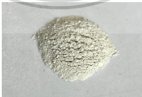
รูปที่ 5.1 ตะกอนที่เกิดขึ้นในอิเล็กโทรลิซิสเซลล์
