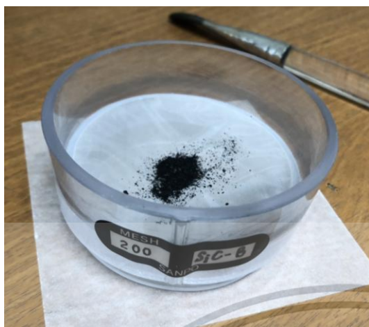
รูปที่ 3.3.2 ผงกราฟีนออกไซด์ที่ถูกบดจนละเอียดแล้วจึงนำไปกรอง
