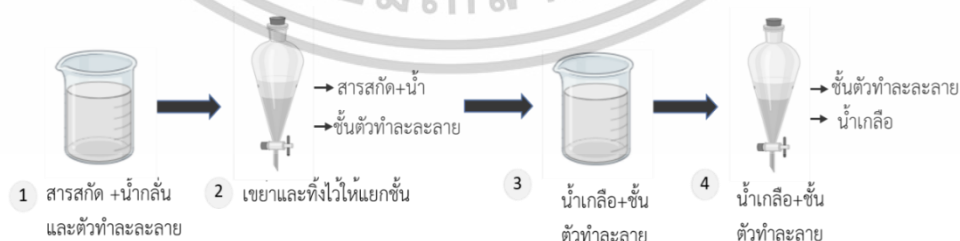
รูปที่ 3.1 ขั้นตอนการสกัดสารด้วยเทคนิค Liquid-liquid extraction ของสารสกัดจากใบและเมล็ดของต้นสารพัดพิษ
