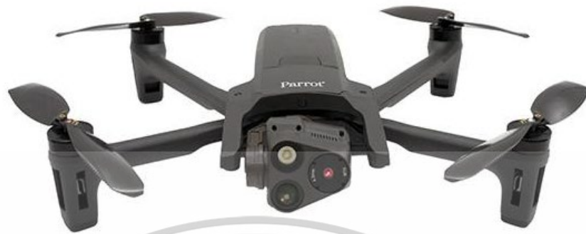
รูปที่ 2.2 อากาศยานไร้คนขับแบบปีกหมุน 4 ใบพัด Parrot รุ่น ANIFI[23]
