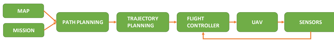
รูปที่ 3.1 ขั้นตอนการควบคุมอากาศยานไร้คนขับให้ปฏิบัติการกิจโดยอัตโนมัติ
