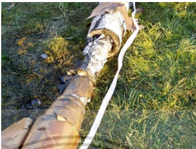
รูปที่ 2.5 ความเสียหายตามแนวแกนของบุชชิง OIP เนื่องจากการเคลื่อนตัวของชั้นตัวนำ [5]
