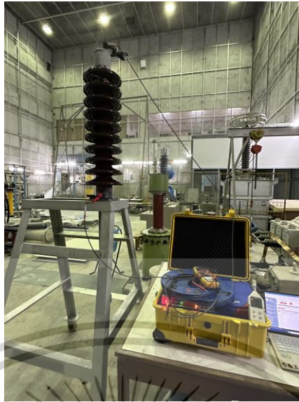
รูปที่ 4.5 วงจรการทดสอบ ผลของ Voltage Bandage / Voltage Collar ต่อผลการทดสอบ FDS/DFR ของบุงซึ่ง 115 กิโลโวลต์
