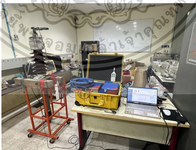
รูปที่ 4.1 วงจรการทดสอบ ผลของการ Guard ต่อผลการทดสอบ FDS/DFR
