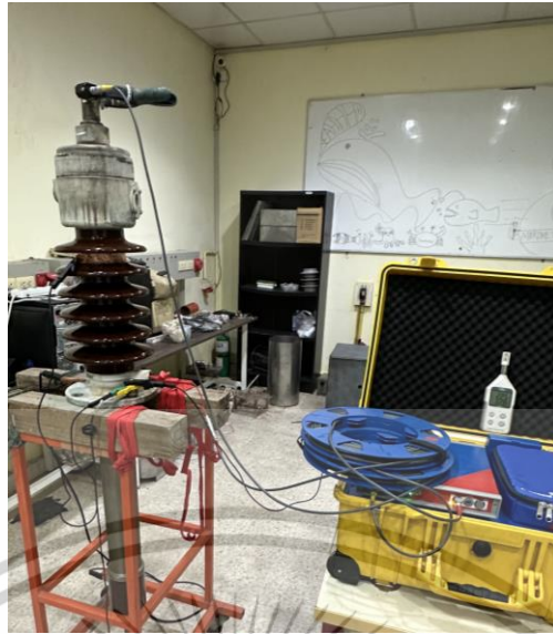
รูปที่ 4.7 วงจรการทดสอบ ผลของ Grounded Bandage / Grounded Collar ต่อผลการทดสอบ FDS/DFR ของบุชชิง 22 กิโลโวลต์
