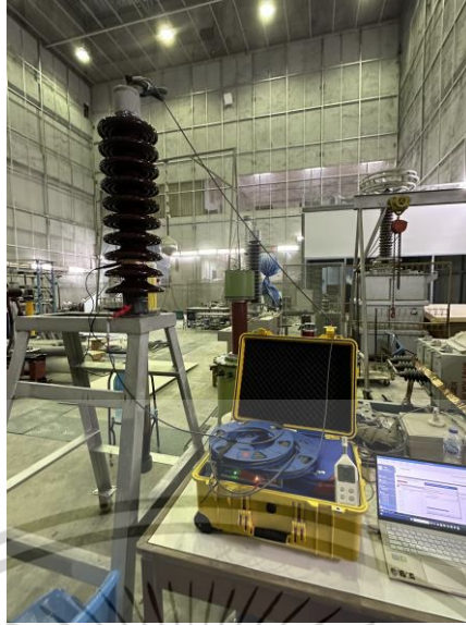
รูปที่ 4.9 วงจรการทดสอบ ผลของ Grounded Bandage / Grounded Collar ต่อผลการทดสอบ FDS/DFR ของบุชชิง 115 กิโลโวลต์
