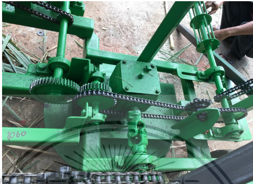
รูปที่ ข.4 การส่งถ่ายกำลังเฟืองตรงและโซ่
