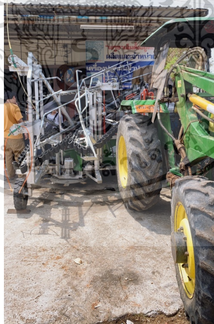
รูปที่ ค.2 แสดงเครื่องเก็บเกี่ยวอ้อยที่นำมาพ่วงท้ายแทรกเตอร์
