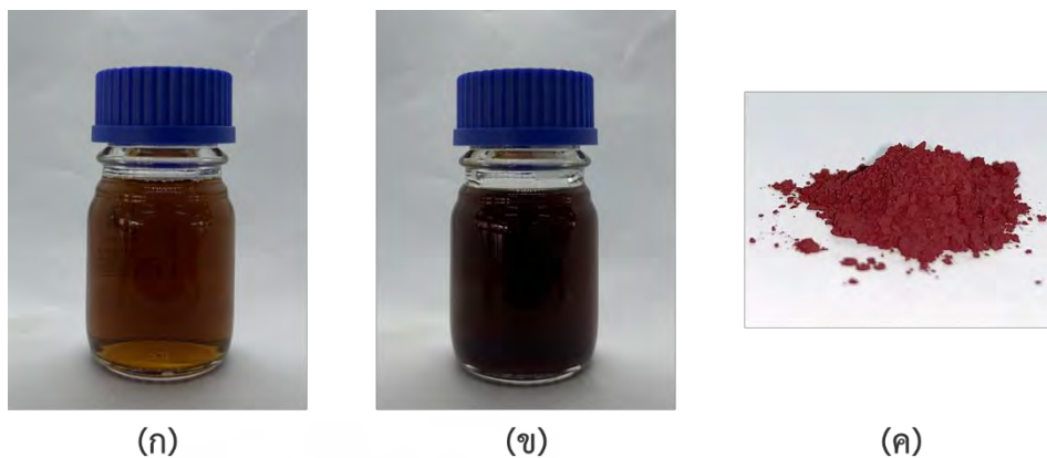
รูปที่ 3.1 ภาพสารละลายตัวอย่าง (ก) ก่อน (ข) หลัง ทำปฏิกิริยาภายใต้เครื่องนึ่งแรงดันไอน้ำ และ (ค) อนุภาคคอปเปอร์ที่ได้จากการสังเคราะห์หลังทำการอบแห้ง
