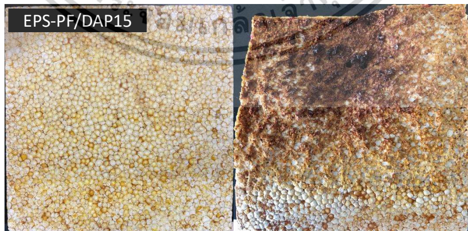
รูปที่ ข.3 โฟมที่เคลือบด้วยสารหน่วงไฟที่มี Diammonium phosphate (DAP) 15%
