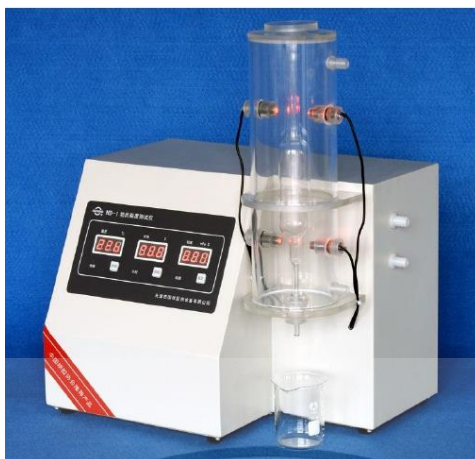
รูปที่ 3.2 เครื่องวัดความหนืดของเจล (Bloom Viscosity Tester)
