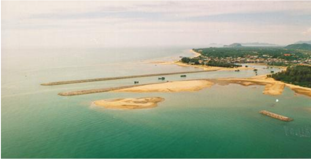
ภาพที่ 9.1 การสะสมตัวของตะกอนรอบบริเวณเขื่อนกันทรายและคลื่นปากร่องน้ำ (Jetty) ที่ปากแม่น้ำปราณบุรี ประเทศไทย
