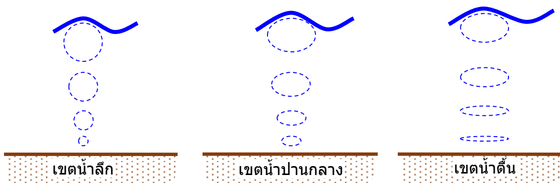
ภาพที่ 4.2 วิถีการเคลื่อนที่ของอนุภาคน้ำในคลื่นในเขตน้ำลึก เขตน้ำปานกลาง และเขตน้ำตื้น
