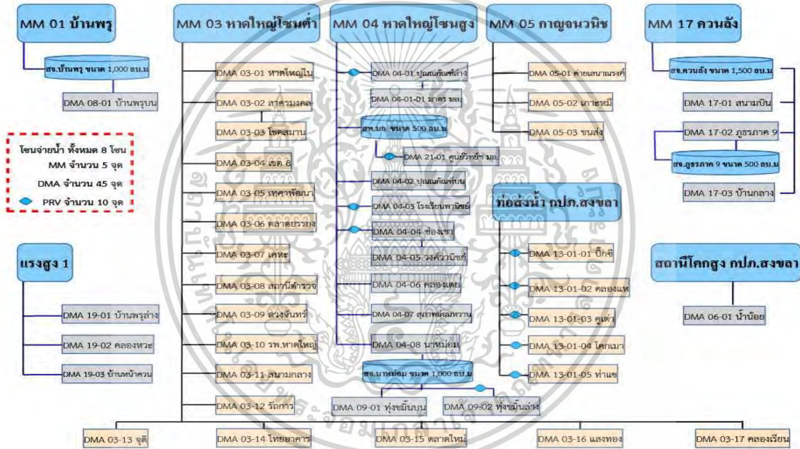
รูปที่ 4.2 แผนผังการจ่ายน้ำ กปภ.สาขาหาดใหญ่ (พ.)
