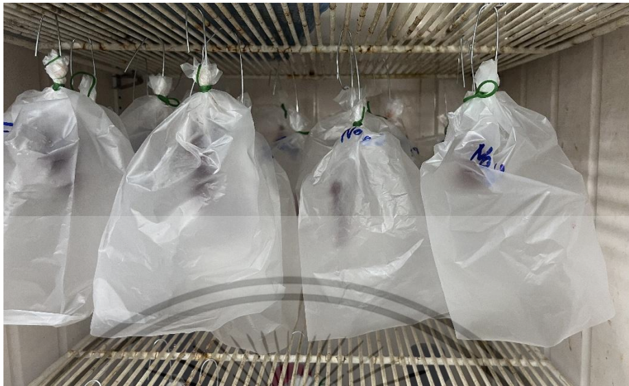
ภาคผนวกที่ ก 11 การแขวนเนื้อสำหรับการทำ Drip loss
