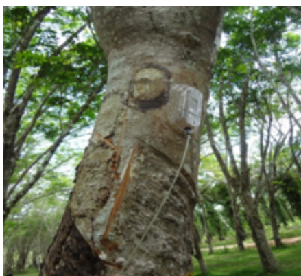
ภาพที่ 2.3 อุปกรณ์ RRIMFLOW ที่ติดตั้งกับต้นยางพารา
