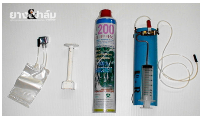
ภาพที่ 2.2 อุปกรณ์ที่ต้องใช้ในการติดตั้งแบบเลท-ไอ
