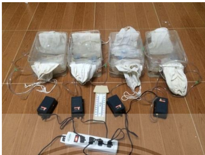
ภาพผนวกที่ 4 การทำ osmopriming ที่อุณหภูมิตั้งไว้ที่ 18 องศาเซลเซียส
