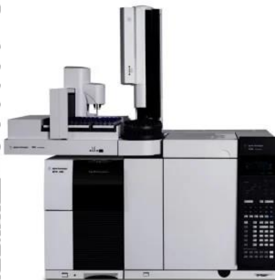
ภาพที่ 3.7 เครื่องมือ GC-MS (สืบค้นจาก: https://www.news-medical.net/59777B-Single-Quadrupole-GCMS-from-Agilent )
