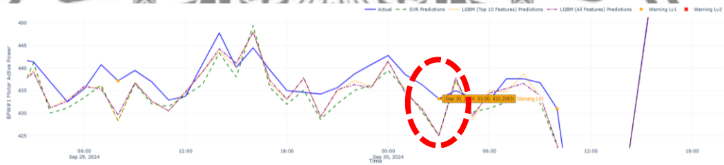
รูปที่ 4.20 กระบวนการยืนยันการตรวจจับความผิดปกติด้วยตัวแบบการทำนายทั้งสามตัวแบบ
