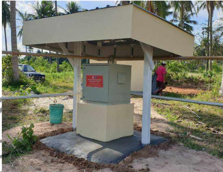
ภาพที่ จ.3 บริเวณจัดเก็บคอมพิวเตอร์แสดงผลการวัดค่าสนามแม่เหล็กโลก
