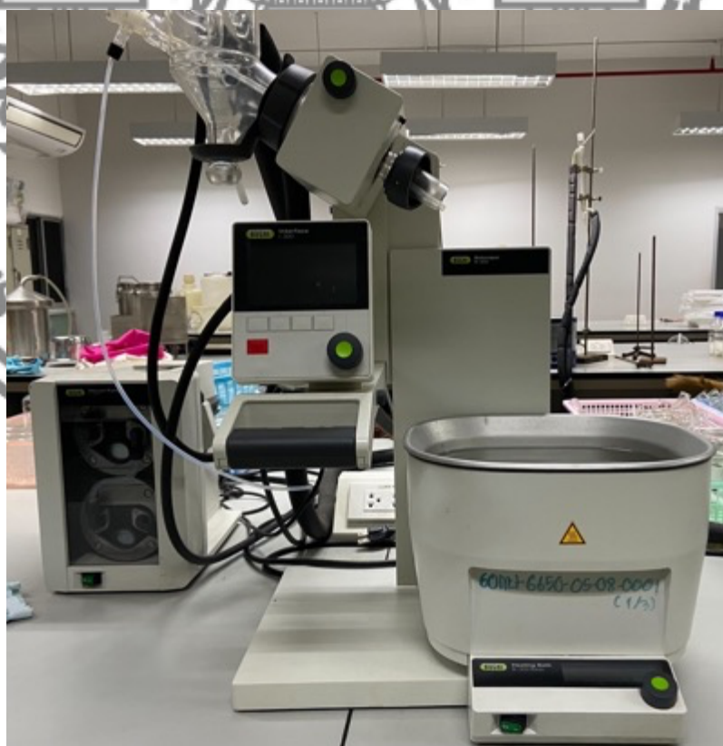
รูปที่ 3.1 เครื่องลดปริมาตรอุณหภูมิต่ำ (rotary evaporator) รุ่น R300 (บริษัท BUCHI)
